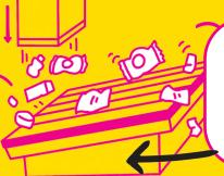
Der **Ballistikseparator** trennt das zu sortierende Material nach verschiedenen Formen – ein wichtiger Schritt in der Sortierung.
