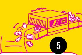
Es gibt viele verschiedene Kunststoffe, die das Licht auf unterschiedliche Weise reflektieren. Der **Nah-Infrarot-Scanner** beleuchtet die Verpackungen entsprechend und unterscheidet zum Beispiel Milchkartons, Zahnpastatuben, Joghurtbecher sowie Spülmittel- und Glasreinigerflaschen.
